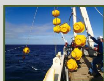
係留系の回収 先端に流速計が取り付けられています
